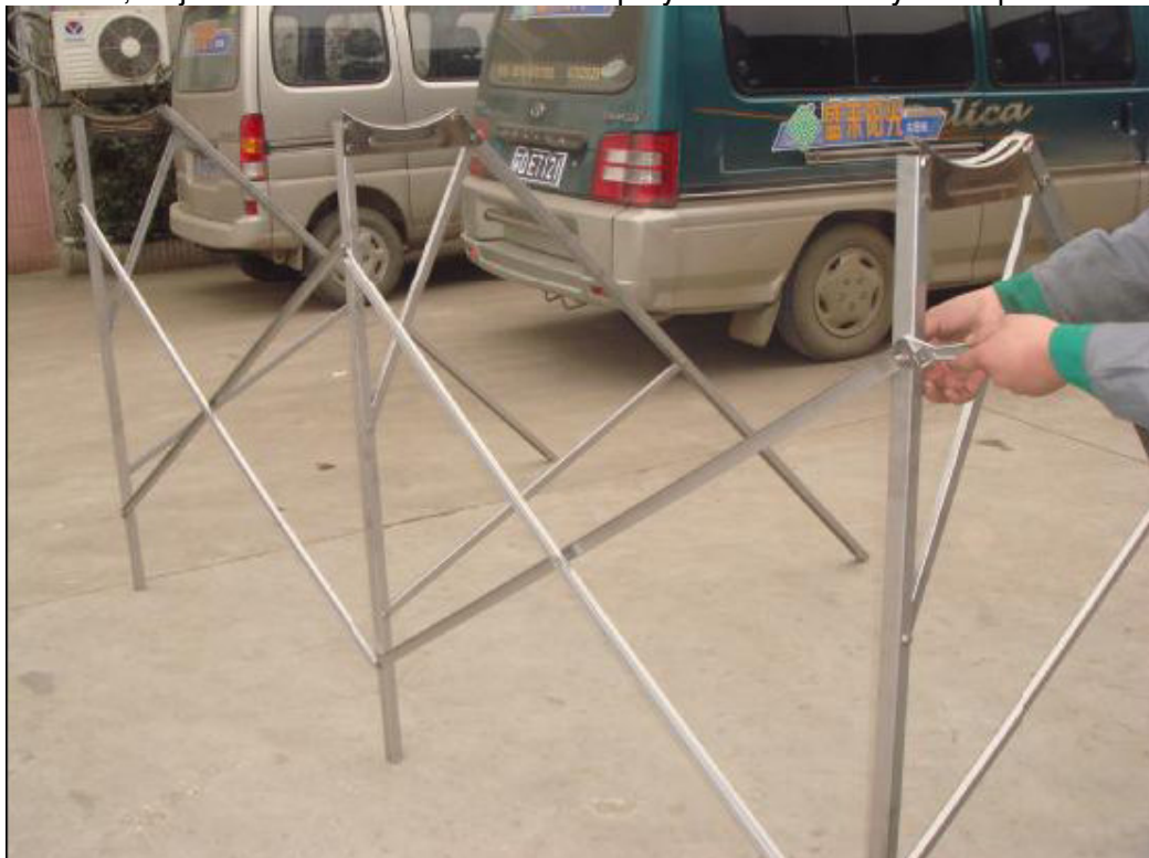
Obr. č. 3: Pripojiť skríženú rozperu s podpornou konštrukciou s jedným párom M8×12 skrutiek tak, aby skrížená konzola bola uprostred konštrukcie.
